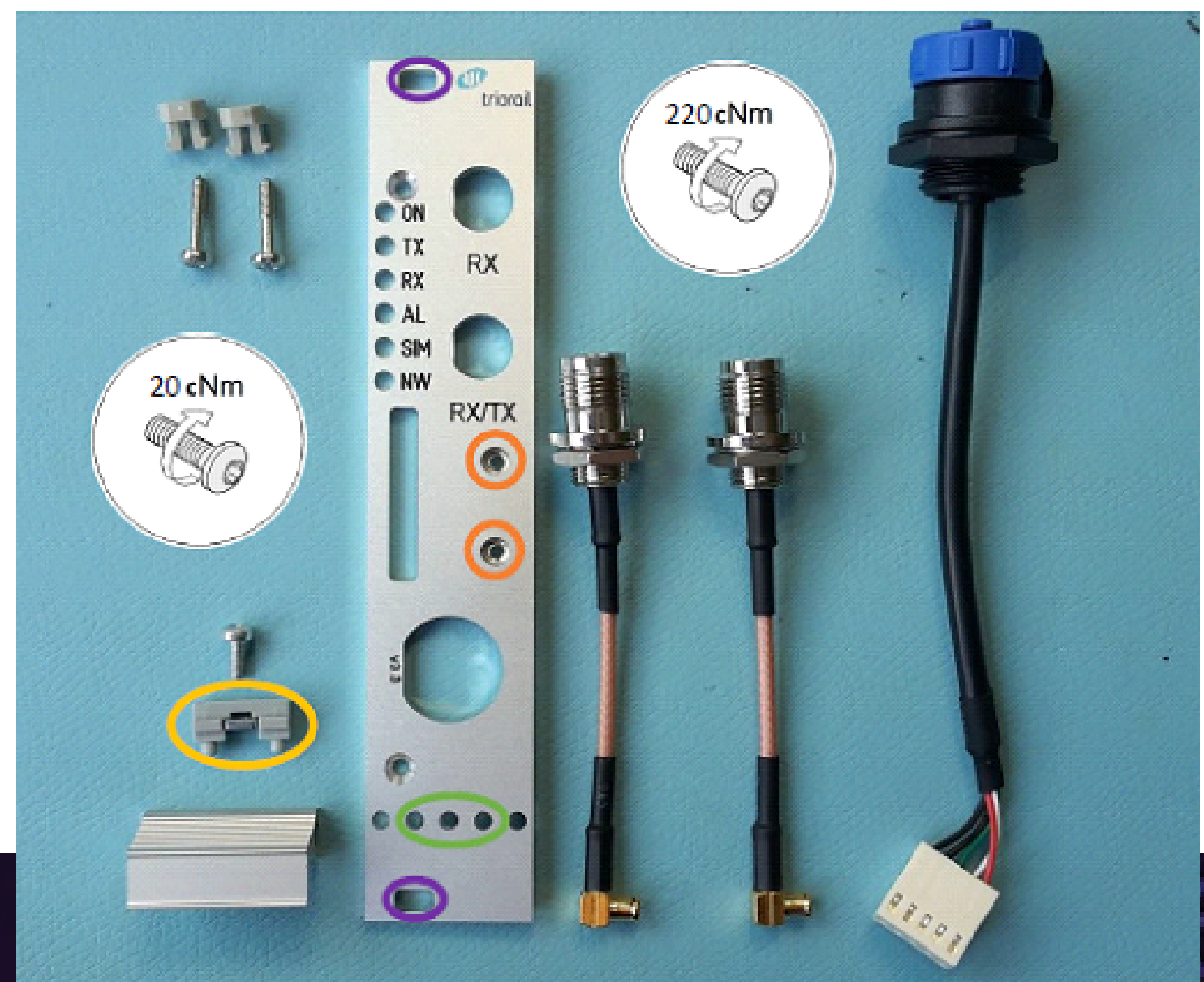
Bildung 9: Montageschritt Zusammenbau Frontblende TRC-5RMe (ext) H
